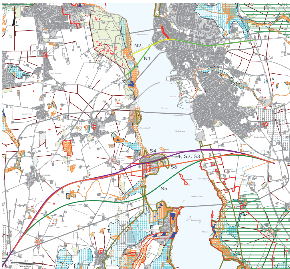
FIGUR 6.6: Oversigt over udvalgte linjeføringsforslag efter den indledende vurdering
